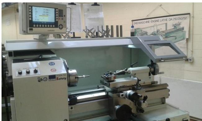
Nach über 36 Jahren war es erforderlich, eine Ersatzbeschaffung für eine Drehmaschine im Bereich der zerspannenden Fertigungstechnik vorzunehmen. Die bis dahin vorhandene Drehmaschine, Baujahr 1980, erfüllte nicht mehr die Anforderungen an die Fertigungsgenauigkeit sowie die Maschinensicherheit in der Werkstatt. Die neue Drehmaschine, Baujahr 2016, verfügt zusätzlich über eine 3-Achsen-Digitalanzeige und ist aufgrund ihrer Maschinenkonzeption besonders für die
