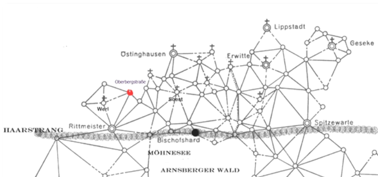
Der nördliche Teil des trigonometrischen Netzes der Landesvermessung im Herzogtum Westfalen von 1810-1816.
