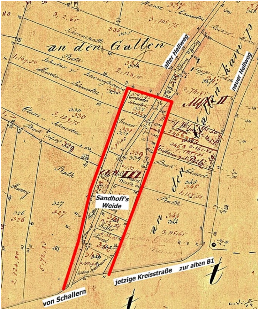
Bild links: Vermessungsriss der Katasterurvermessung der Gemeinde Schallern, 1828, vergrößerter Ausschnitt. Angaben der Flächen (rot) in Morgen, Quadratruten, Quadratfuß. Original: Archiv Katasteramt Kreis Soest
