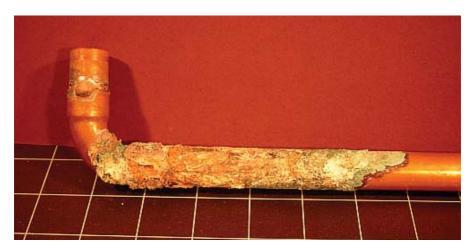
Ausgebautes Rohrteilstück mit unbemerkt, "schleichend", entstandenem Wasserschaden
